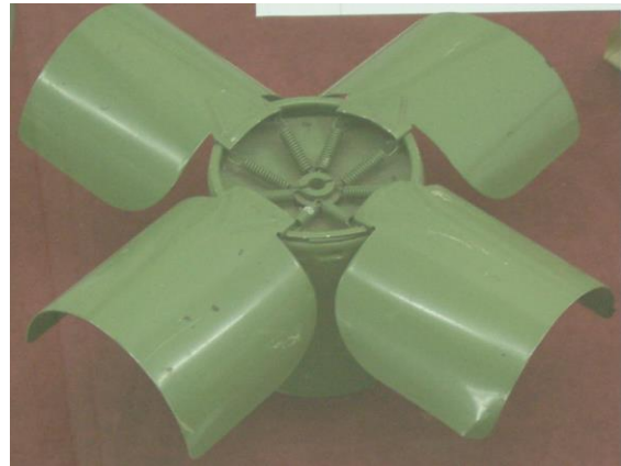
Protiv-oklopna submunicija iz bojeve glave rakete 262 mm M87 (Orkan) za zaprečavanje tenko prohodnih pravaca
